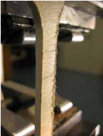
KUVIO 13. Koivuviilulla pinnoitettu abs-muovi vedon jälkeen
