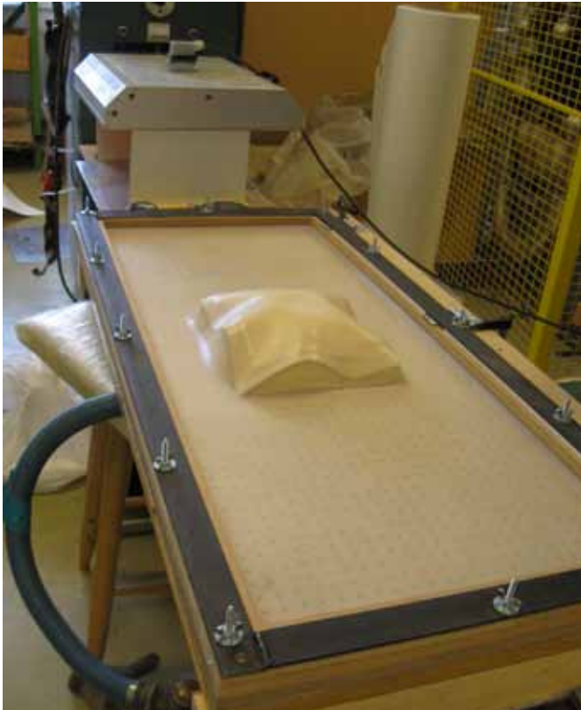
KUVIO 19. Puristuskokeita varten valmistettu tyhjiömuovauslaite
