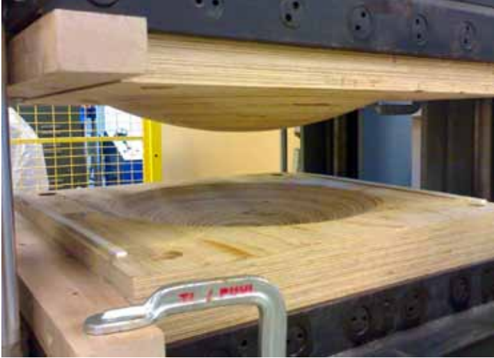
KUVIO 17. Perinteinen vanerista valmistettu 3D-muotti
