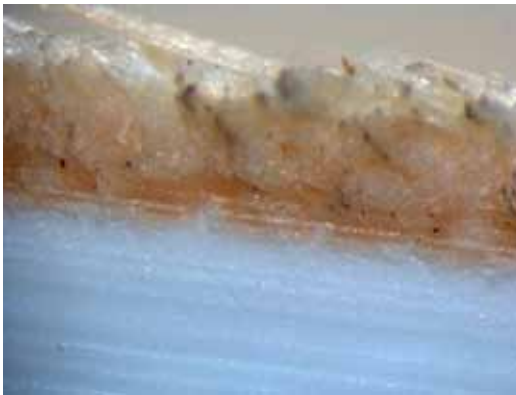
KUVIO 10. Abs-muovi sulaneena mikrohalkeamiin
