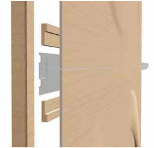
KUVA 25. Seinälevyn piilokiinnityksen rakenne mallinnus Olli Kilpi.
